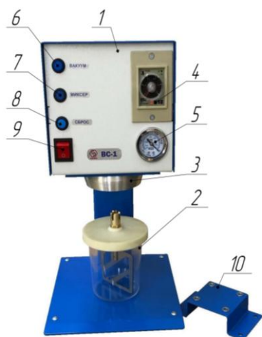
Рисунок 1. Общий вид смесителя: 1 - корпус; 2 - стакан; 3 – фланец с сменным фильтром; 4 - таймер; 5 - вакуумметр; 6 - кнопка "Вакуум"; 7 - кнопка "Миксер"; 8 - кнопка "Сброс"; 9 - кнопка "Сет"
